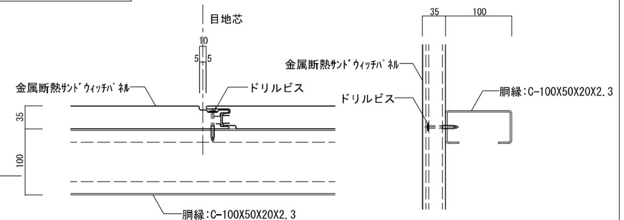
金属サトウウィッチャ® 札取付平面図 S=1/5
