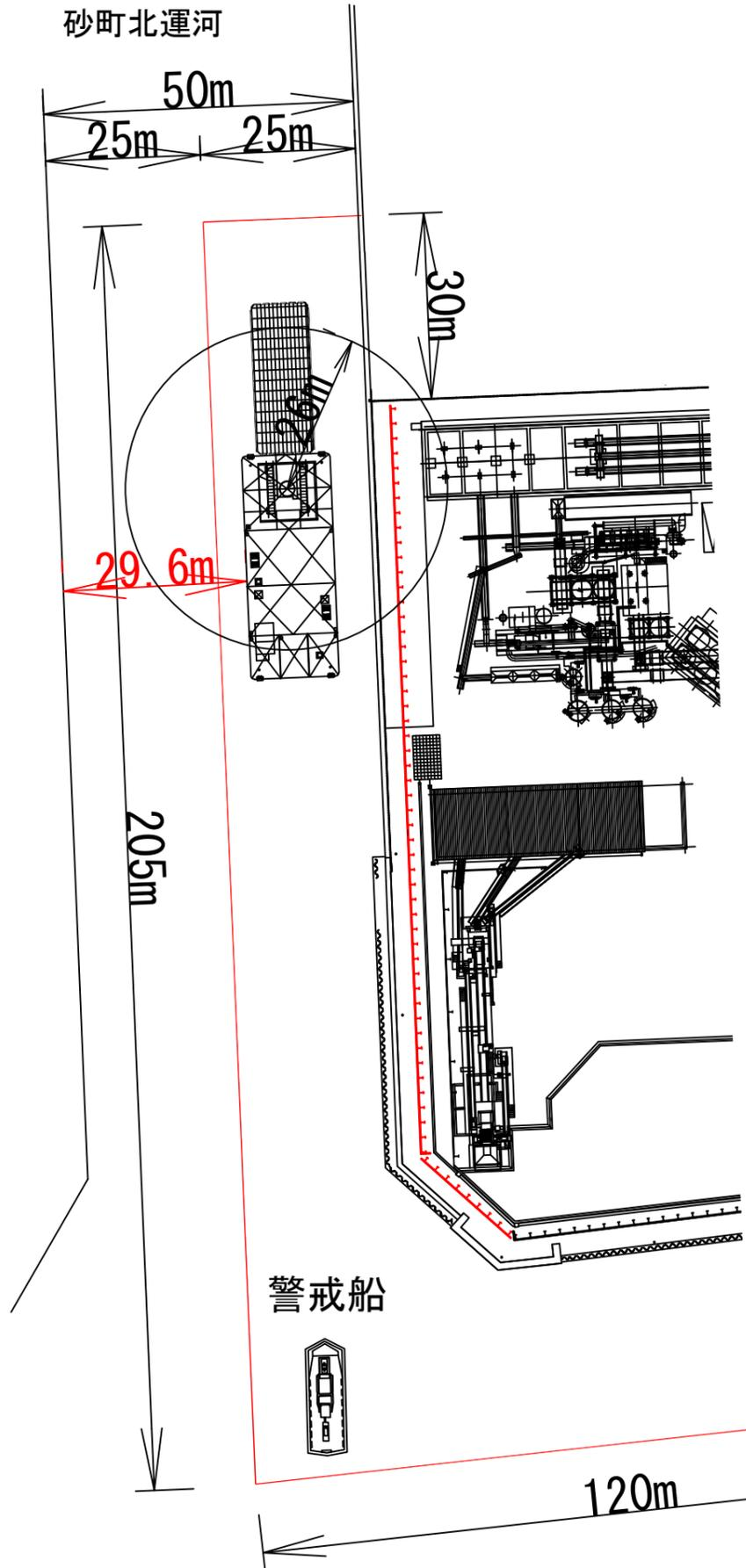
砂町北運河南側施工時の船舶配置図
